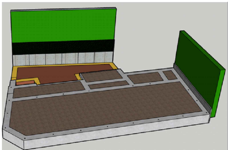
3 – ZASYPÁNÍ PASŮ – SPODNÍ ČÁST
