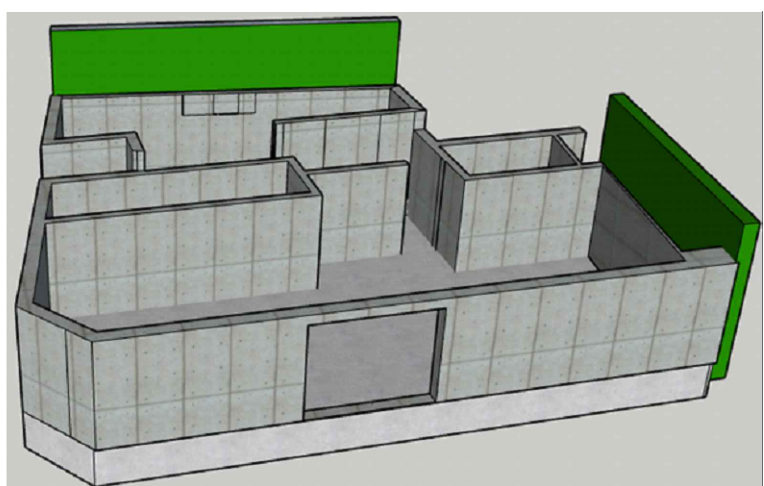
12 – ŽB STROP NAD 1 PP – HORNÍ A ZTUŽUJÍCÍ ZÍDKY
